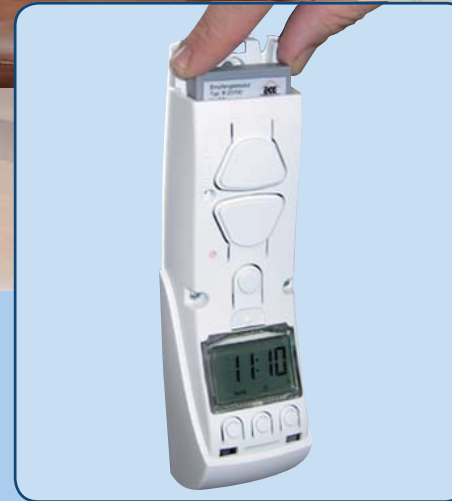
Schacht für Empfangsmodul bei Bedienteil der Wellenmotore Typ 4 & Typ 5
