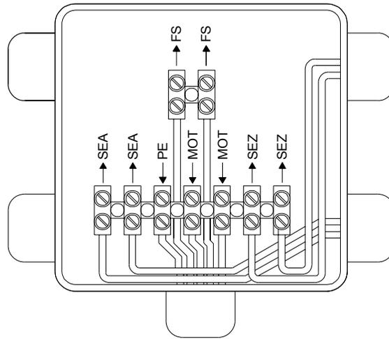
Die Steuerung MO 90 sollte so nah wie möglich (am besten direkt neben der Motorsteuerung des Torantriebes) am Tor montiert werden. Die Leitungseinführungen müssen unbedingt von unten erfolgen. Beachten Sie den Mindestleitungsquerschnitt von 1,5mm<sup>2</sup>. Eine Optimale Installation ist eine gemeinsame Montage beider Motorsteuerungen in einem großen Steuerungsgehäuse.
