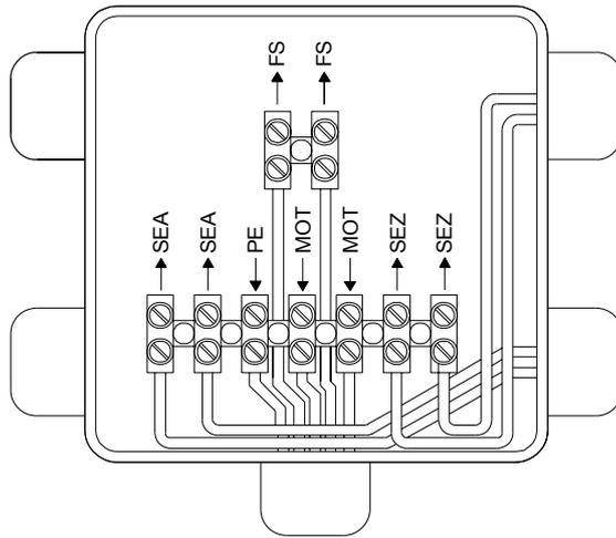
La logique de commande MO 90 doit être installée aussi près que possible (directement à côté de la logique de commande de l'automatisme) sur le portail. Les conduites des câbles doivent venir impérativement d'en bas. Respectez les sections de ligne minimum nécessaires 1,5mm<sup>2</sup>. Pour avoir une installation optimale, montez les deux logiques dans un seul grand boîtier.
