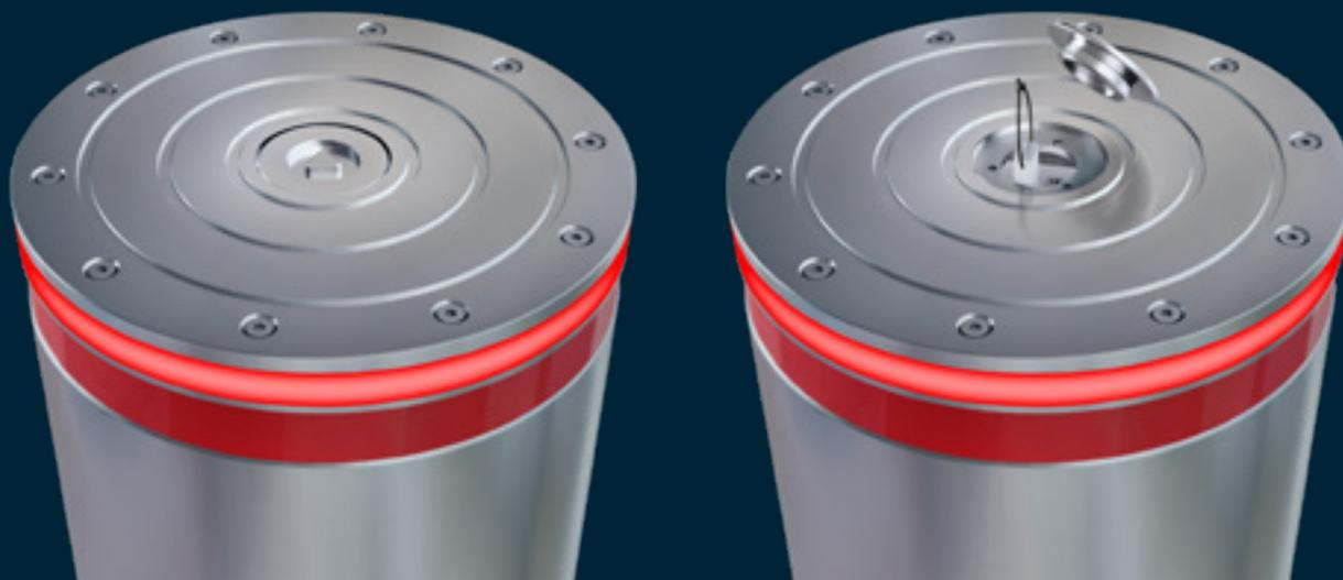
Die manuelle Notentriegelung erfolgt direkt am Deckel des Pollers. Die kleine Abdeckung wird entfernt, z.B. über einen Feuerwehr-Dreikant. Die Notentriegelungsstange wird an der Zugschleife herausgezogen und der Poller fällt sofort nach unten.
