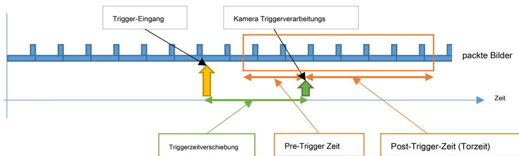
Bitte beachten Sie, dass im Falle eines „Trigger-Start“ wird die Verarbeitung zu stoppen, wenn entweder der Gate-Zeit abgelaufen ist, oder die „Trigger-Stop“ Nachricht empfangen wird.
