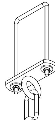
**2.** Die an den Ketten befestigten Flachstähle auf die Gewinde der Bügel setzen und mit den Muttern leicht fixieren
