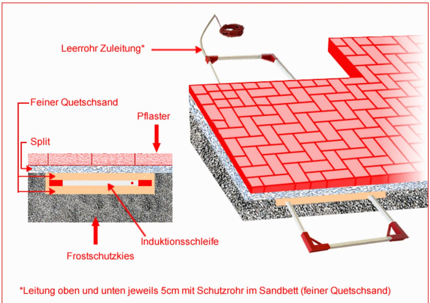
Die Schleifen werden in die Sandschicht zwischen der unteren Schotterschicht (Frostschutzkies) und der Splitschicht gelegt. Die Induktionsschleife ist im Kabelrohr fest vergossen, dadurch entstehen keine Störungen bei Vibrationen, z.B. bei LKW Verkehr.
