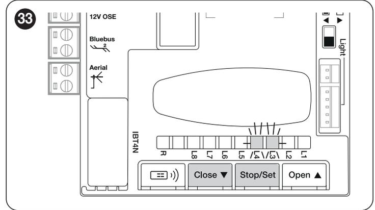
Dieser Vorgang ermöglicht die schnelle Programmierung der Öffnungs- und Schließabstände und ermöglicht der Steuerung die automatische Berechnung der Zwischenpositionen, die später über die App „myNice Pro“ und die kompatiblen Schnittstellen geändert werden können.
