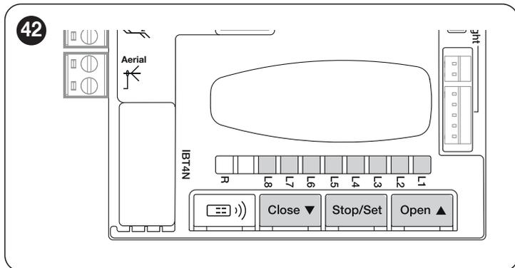
Die verfügbaren programmierbaren Funktionen sind auf **zwei Ebenen** organisiert und ihr Betriebsstatus wird von den acht LEDs „L1 ... L8“ an der Steuerung angezeigt (LED eingeschaltet = Funktion aktiviert; LED ausgeschaltet = Funktion deaktiviert).
