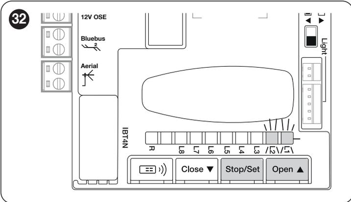
Die Einlernphase der angeschlossenen Vorrichtungen kann jederzeit auch nach der Installation wiederholt werden, wenn zum Beispiel ein Gerät hinzugefügt oder entfernt wird.
