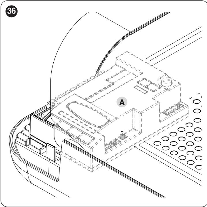
Mit dem wie in **Abbildung 37** positionierten Schalter (**Standardeinstellung, typische Installation**) erfolgt die Öffnung der Automation durch Bewegen des Tors in Motorrichtung. Die Schließbewegung erfolgt in Richtung des Bodens.
