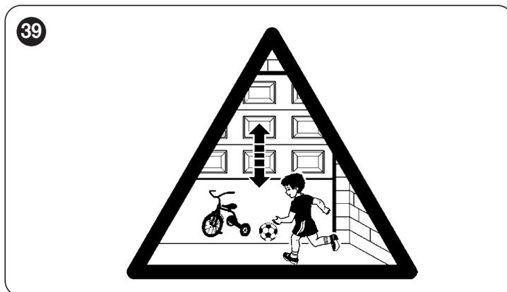
4. Am Tor ein Schild anbringen, das mindestens folgende Daten enthält: Automatisierungstyp, Name und Adresse des Herstellers (Verantwortlicher der „Inbetriebnahme“), Seriennummer, Baujahr und CE-Kennzeichnung
