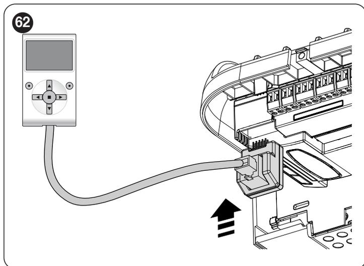
Die Einheit Oview kann gleichzeitig an mehrere Steuerungen angeschlossen werden (bis zu 16 Steuerungen ohne besondere Vorkehrungen). Die Einheit kann auch während des Normalbetriebs der Automation angeschlossen bleiben. In diesem Fall kann sie dazu verwendet werden, um die Befehle direkt an die Steuerung zu senden, indem das spezifische Menü „Anwender“ genutzt wird.
