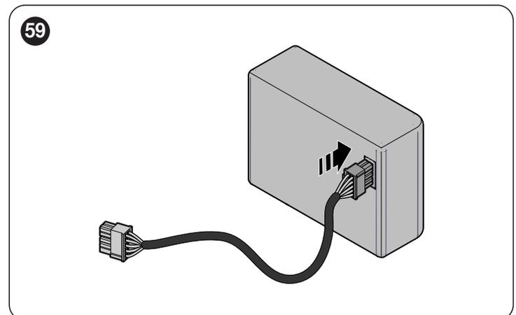
4. den entsprechenden Steckverbinder (C) auf dem vom Motorfach kommenden Steckverbinder einsetzen ("Abbildung 60")
