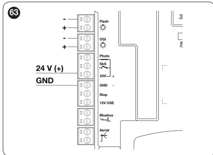
**Achtung!** Höhere Lasten (max 10W - 24V) müssen an den Flash- bzw. OGI-Ausgang angeschlossen werden, nachdem dieser mit der Always On-Funktion umkonfiguriert wurde (siehe Kapitel *Ausgänge der Steuerung konfigurieren*). Deaktivieren Sie ggf. die Standby-Funktion.
