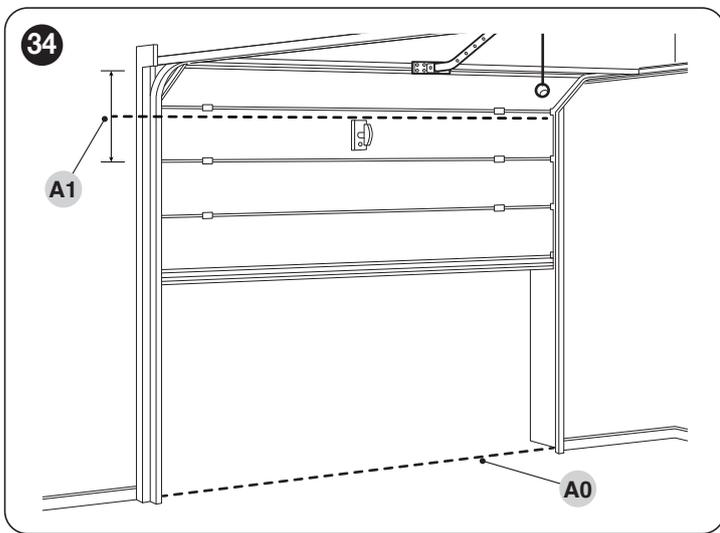
**Achtung!** Bei der Programmierung der Positionen (über die Tasten der Steuerung) ist ein Timeout vorgesehen: Nach Start der Programmierfunktion stehen bei jedem Bewegungsbefehl 60 Sekunden zur Verfügung. Wird innerhalb dieser Zeit keine Taste gedrückt, endet der Vorgang automatisch und der Vorgang muss neu begonnen werden.
