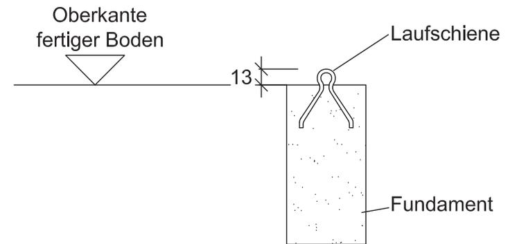
Achtung! Zeichnung Schiebetor DIN Links, bei Montage DIN Rechts Zeichnung spiegeln
