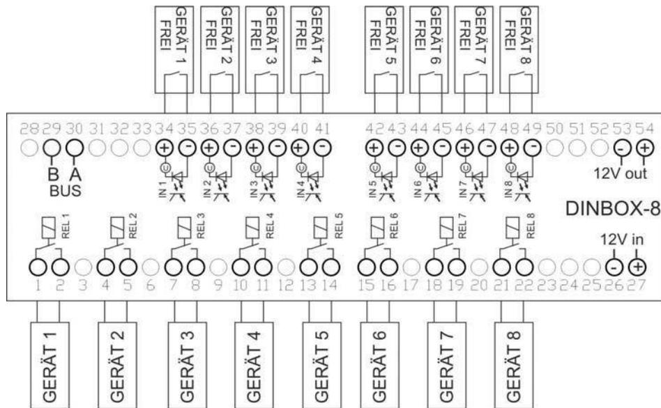
Abb. 7-10 Anschlussbelegung Einsatzbereich Waschmaschine
