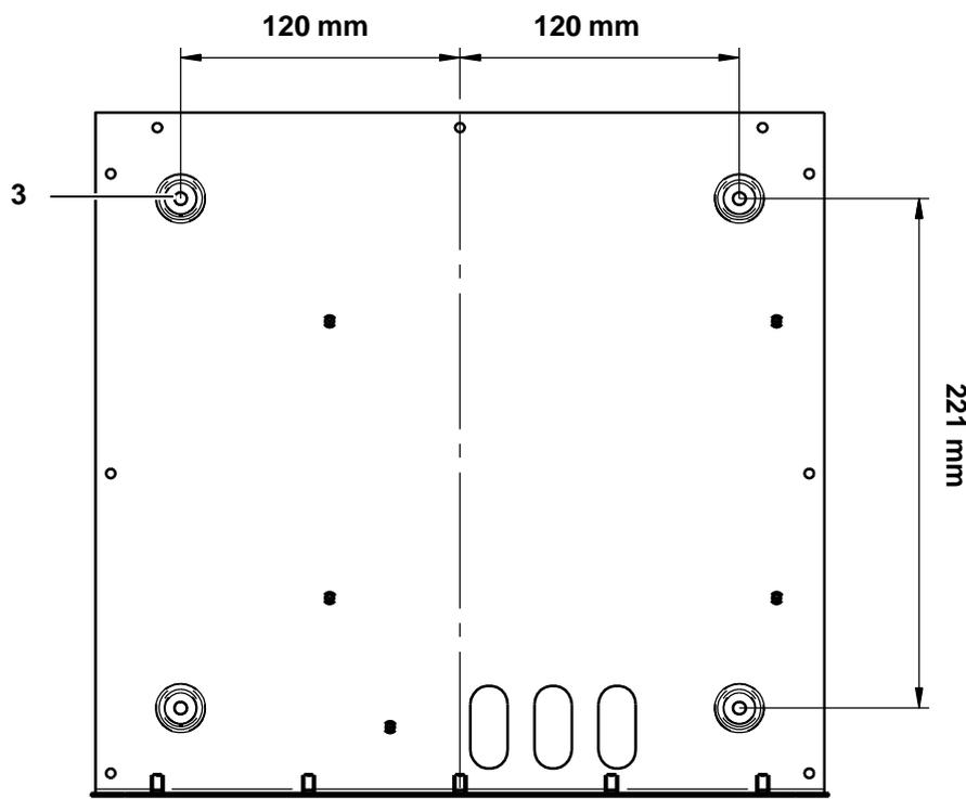
Abb. 5-3 Geräteansteuerung befestigen
