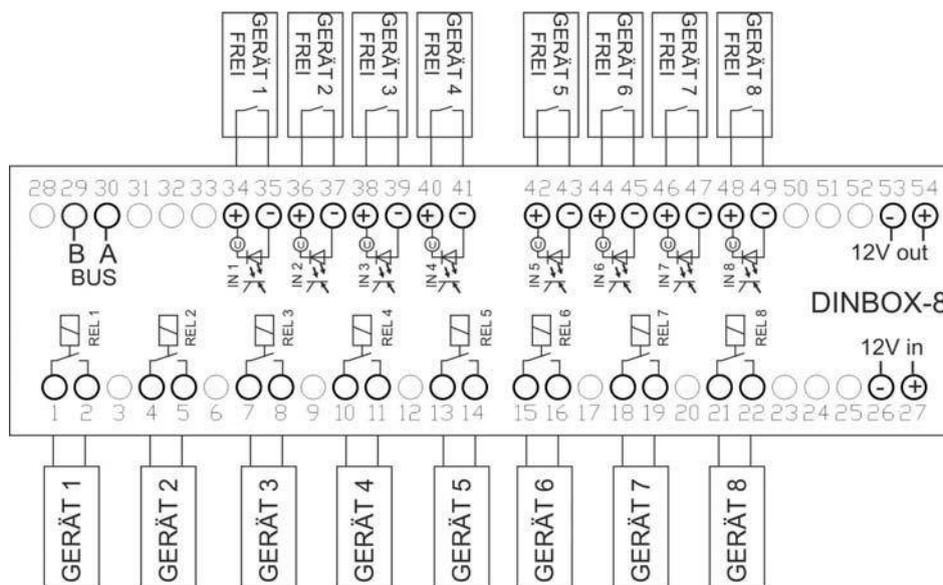
Abb. 7-17 Anschlussbelegung Einsatzbereich WC/-Türen mit Verriegelungsrückmeldung
