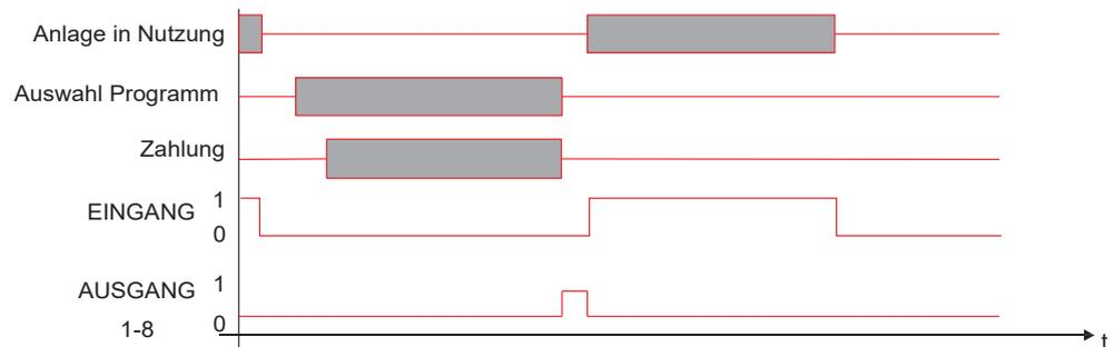
Abb. 7-16 Diagramm Zeitverlauf beim Waschanlagenbetrieb mit Programmauswahl
