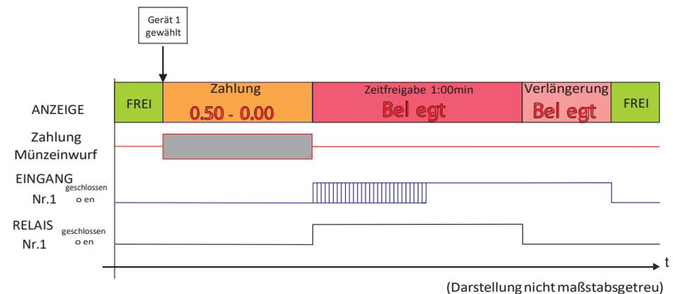
Abb. 7-19 Diagramm Zeitverlauf bei WC-Türansteuerung im Zeitbetrieb
