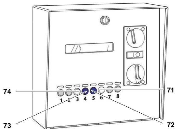
Abb. 7-9 Exemplarische Navigation im Programmiermodus am Wandgehäuse
