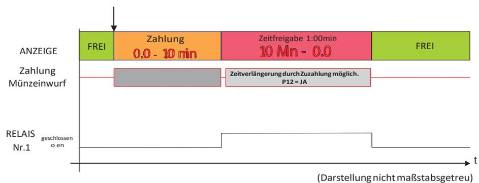
Abb. 7-22 Standard Zeitbetrieb Trockner
