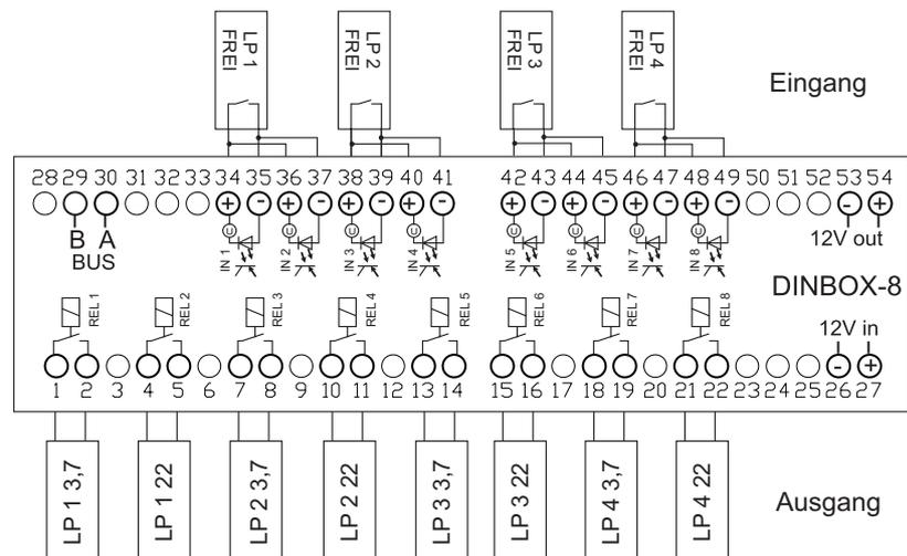
Abb. 7-26 Anschlussbelegung für Einsatzbereich Stromtankstelle
