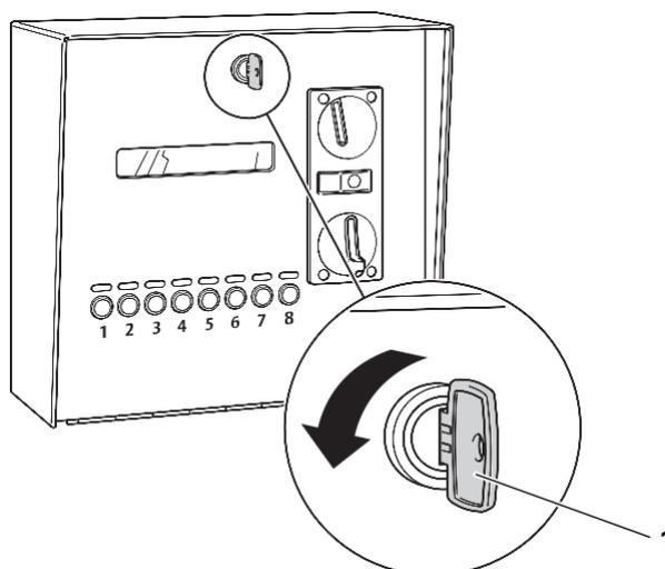
Abb. 5-1 Schloss für den Deckel öffnen
