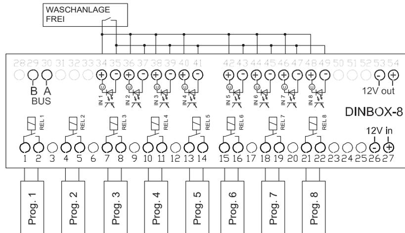
Abb. 7-15 Anschlussbelegung Waschanlagenbetrieb mit Programmauswahl
