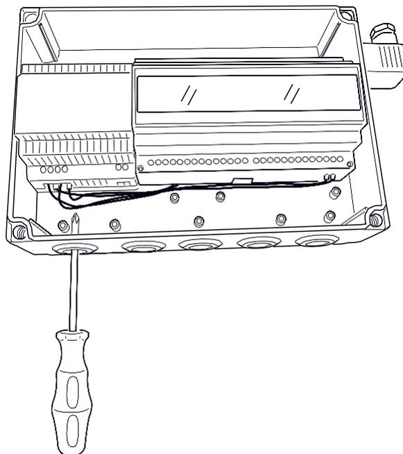
Abb. 5-13 Spritzschutztülle durchstoßen
