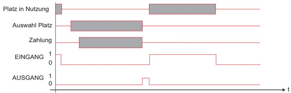
Abb. 7-14 Diagramm Zeitverlauf beim Einzelplatzbetrieb Staubsauger
