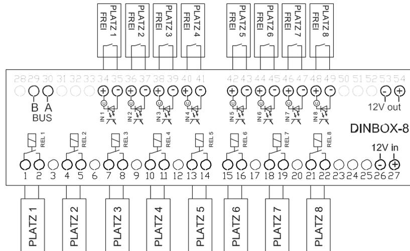
Abb. 7-13 Anschlussbelegung Einzelplatzbetrieb Staubsauger
