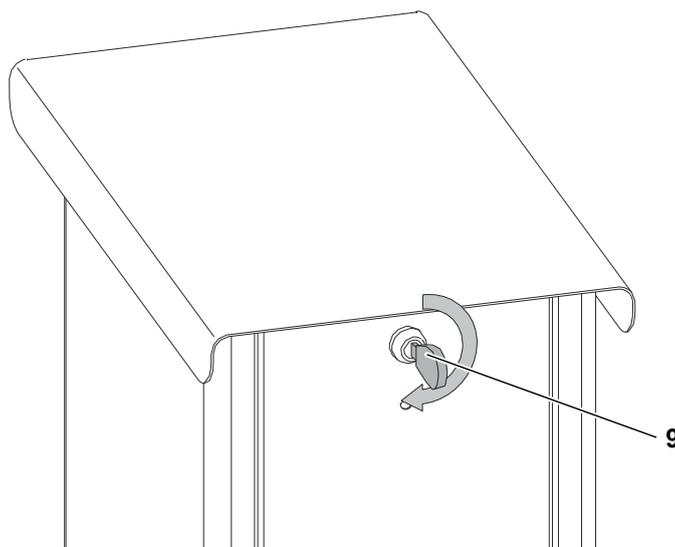
Abb. 5-5 Schloss für den Deckel öffnen
