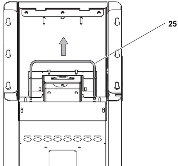
Abb. 5-7 Entriegelungshebel für die hintere Abdeckung
