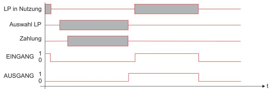
Abb. 7-27 Diagramm Zeitverlauf für Einsatzbereich Stromtankstelle
