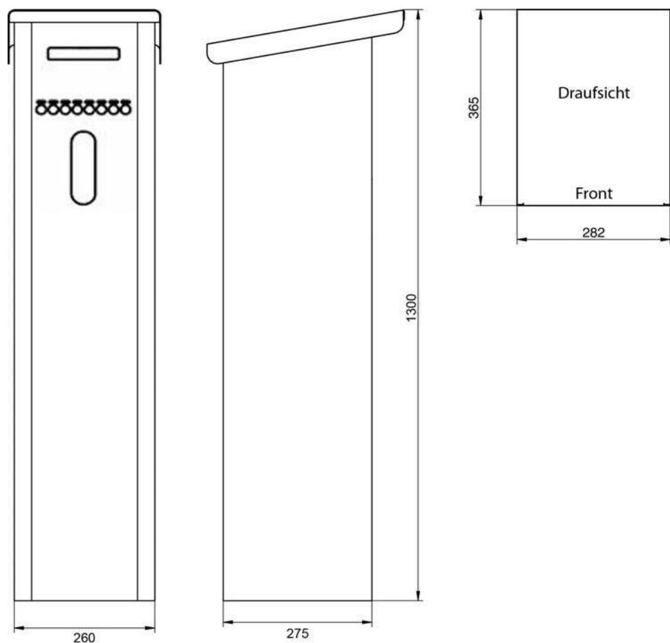
Abb. 2-2 Abmessungen Bedieneinheit im Säulengehäuse
