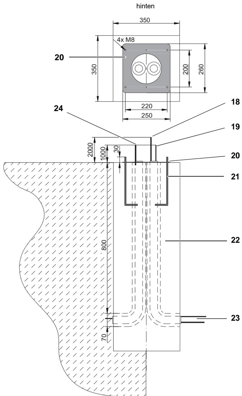
Abb. 5-4 Fundament Säulengehäuse
