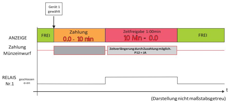
Abb. 7-11 Beispiel 1: Standard Zeitbetrieb Waschmaschine
