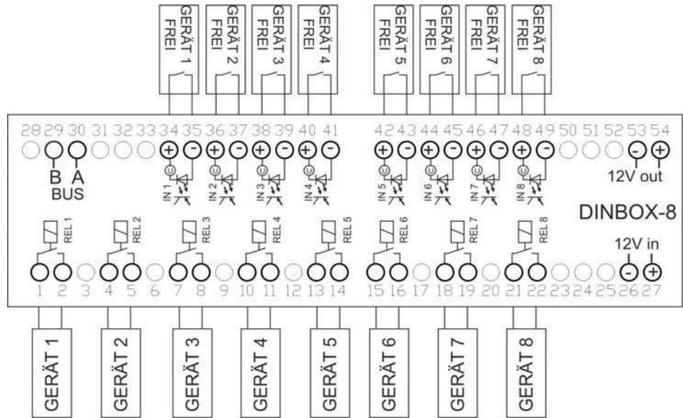
Abb. 7-20 Anschlussbelegung Waschsalon im Mischbetrieb Impuls- sowie Zeitsteuerung
