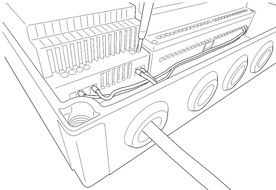
Abb. 5-14 230 V Versorgungsleitung anschliessen
