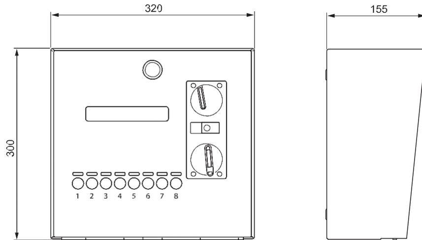
Abb. 2-1 Abmessungen Bedieneinheit im Wandgehäuse
