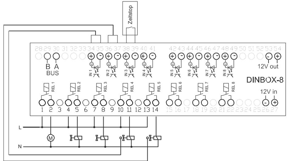
Abb. 7-24 Anschlussbelegung Einsatzbereich Hochdruckreiniger mit Programmwechsel
