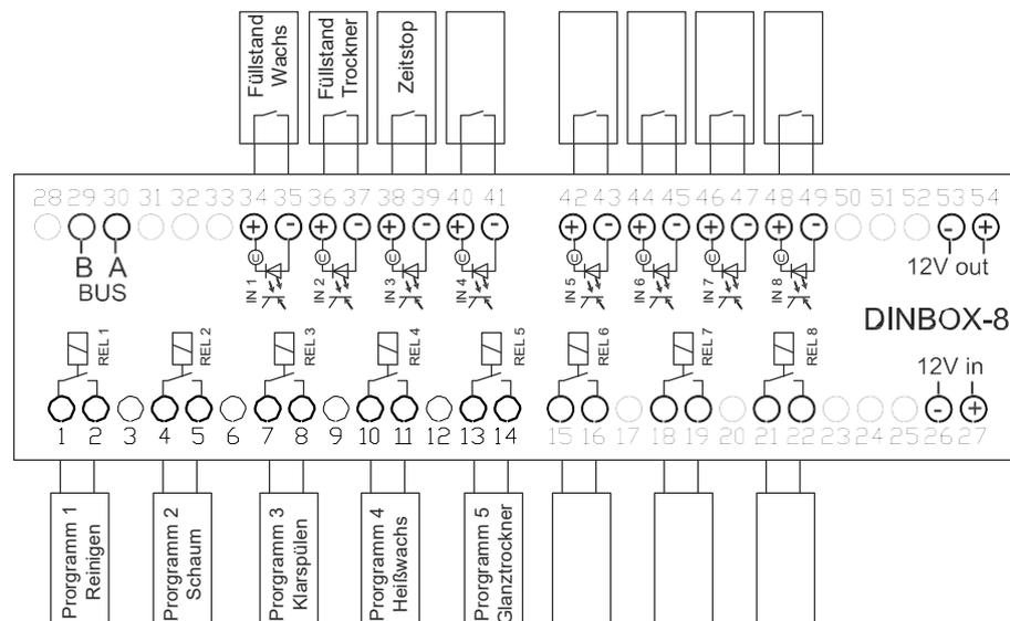
Abb. 7-23 Programbelegung Einsatzbereich Hochdruckreiniger mit Programmwechsel
