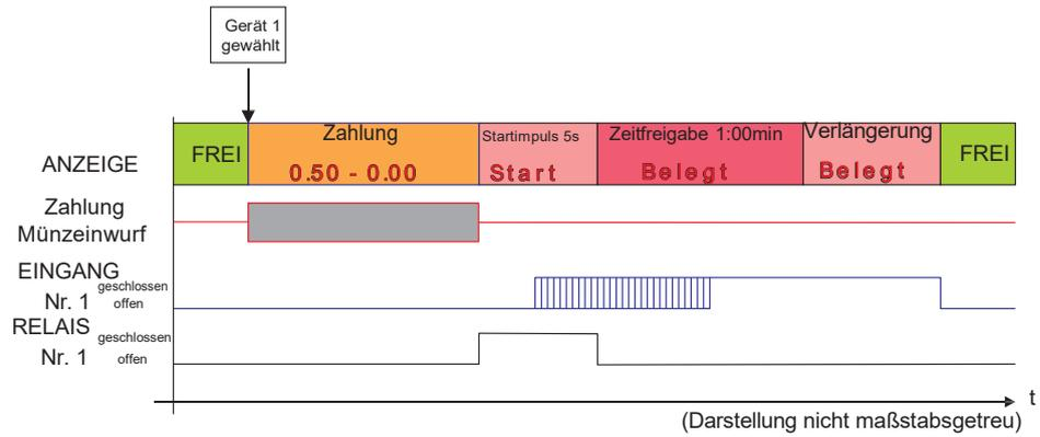
Abb. 7-18 Diagramm Zeitverlauf bei WC-Türansteuerung im Impulsbetrieb
