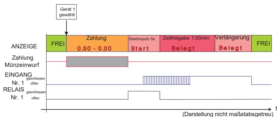
Abb. 7-21 Diagramm Waschmaschine mit Impulsstart, Reservierzeit und Fertigrückmeldung
