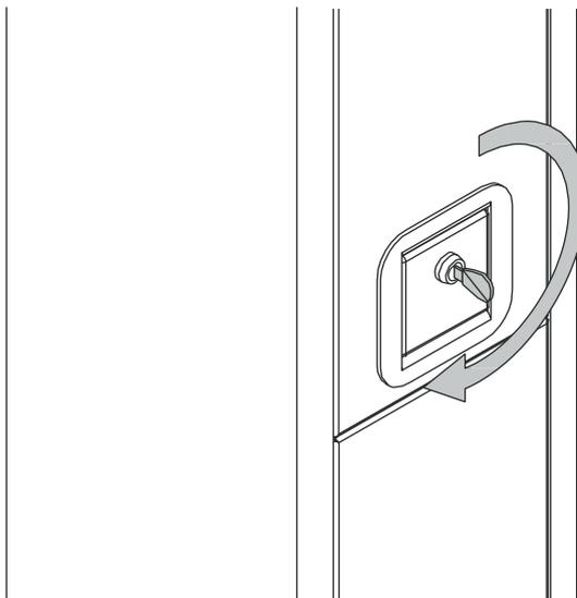
Abb. 6-11 Münzbehälter aufschließen
