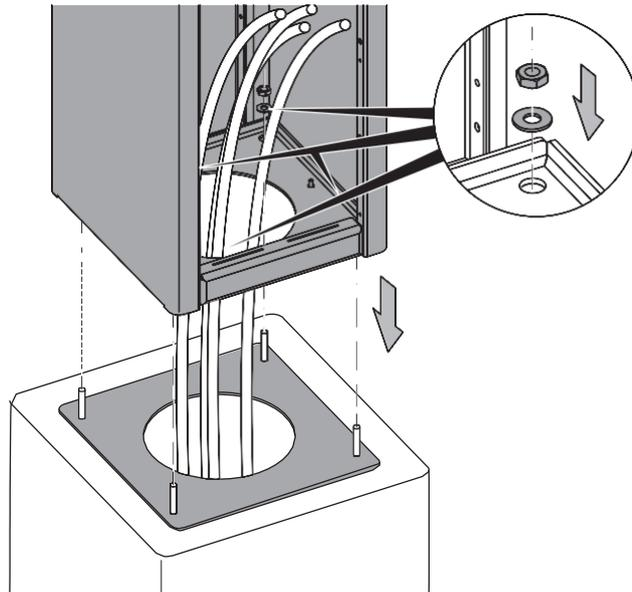
Abb. 5-10 Master-Säule mit dem Fundament verschrauben
