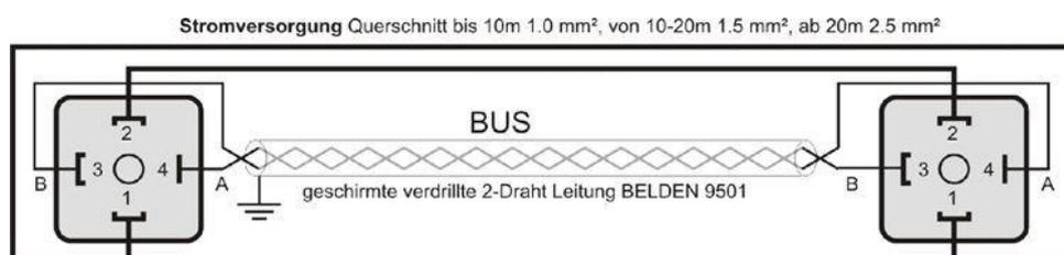
Abb. 5-11 Schema GDM Stecker und Bus-Kabel
