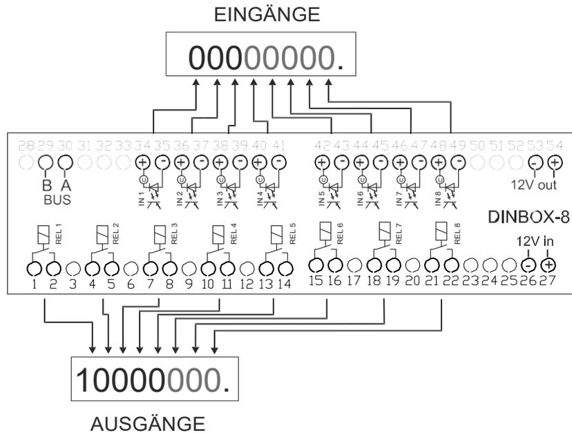
Abb. 7-25 Parameterzuordnung Einsatzbereich Hochdruckreiniger mit Programmwechsel
