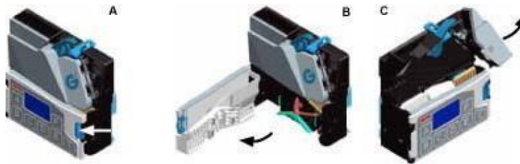
Abb. 9-2 Sortierabdeckung und Laufbahnträger des Münzprüfers öffnen
