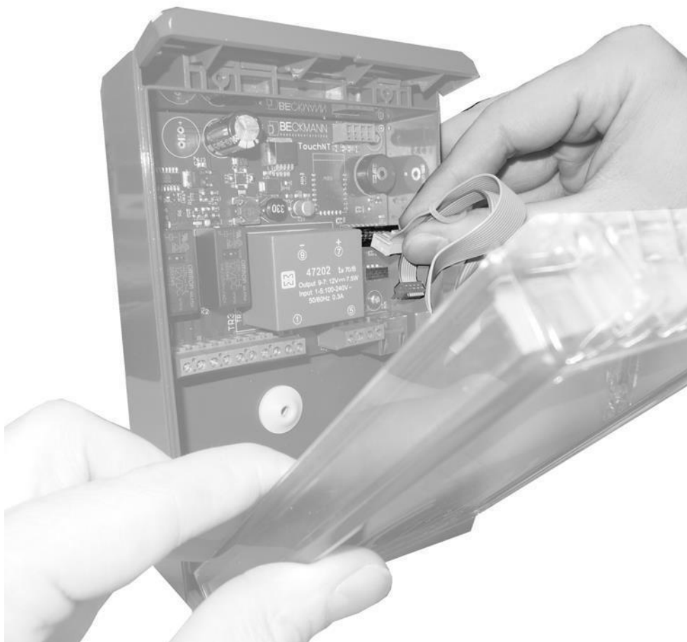
Abb. 5-4 Stecker abstecken und Bedienfront abnehmen
