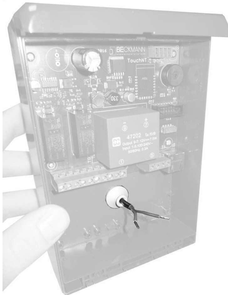
Abb. 5-6 Kabelverlegung ins Gehäuse
