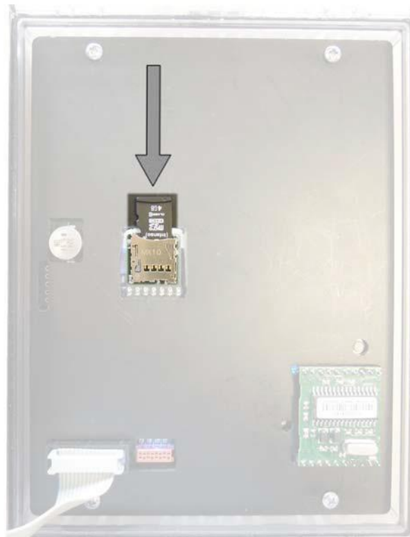
Abb. 9-1 Softwareupdate MicroSD-Karte stecken
