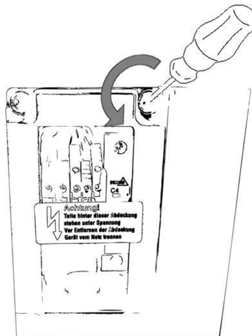
Abb. 6-3 Deckel der Anschluss-Isobox Spannungsversorgung lösen
