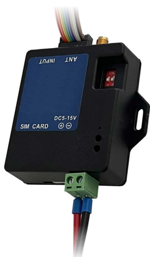
GSM Handy Alarm ohne SIM-Karte, 5-15V DC Eingangsspannung Alarmierung per SMS informiert Nutzer über niedrigen Batteriestand
