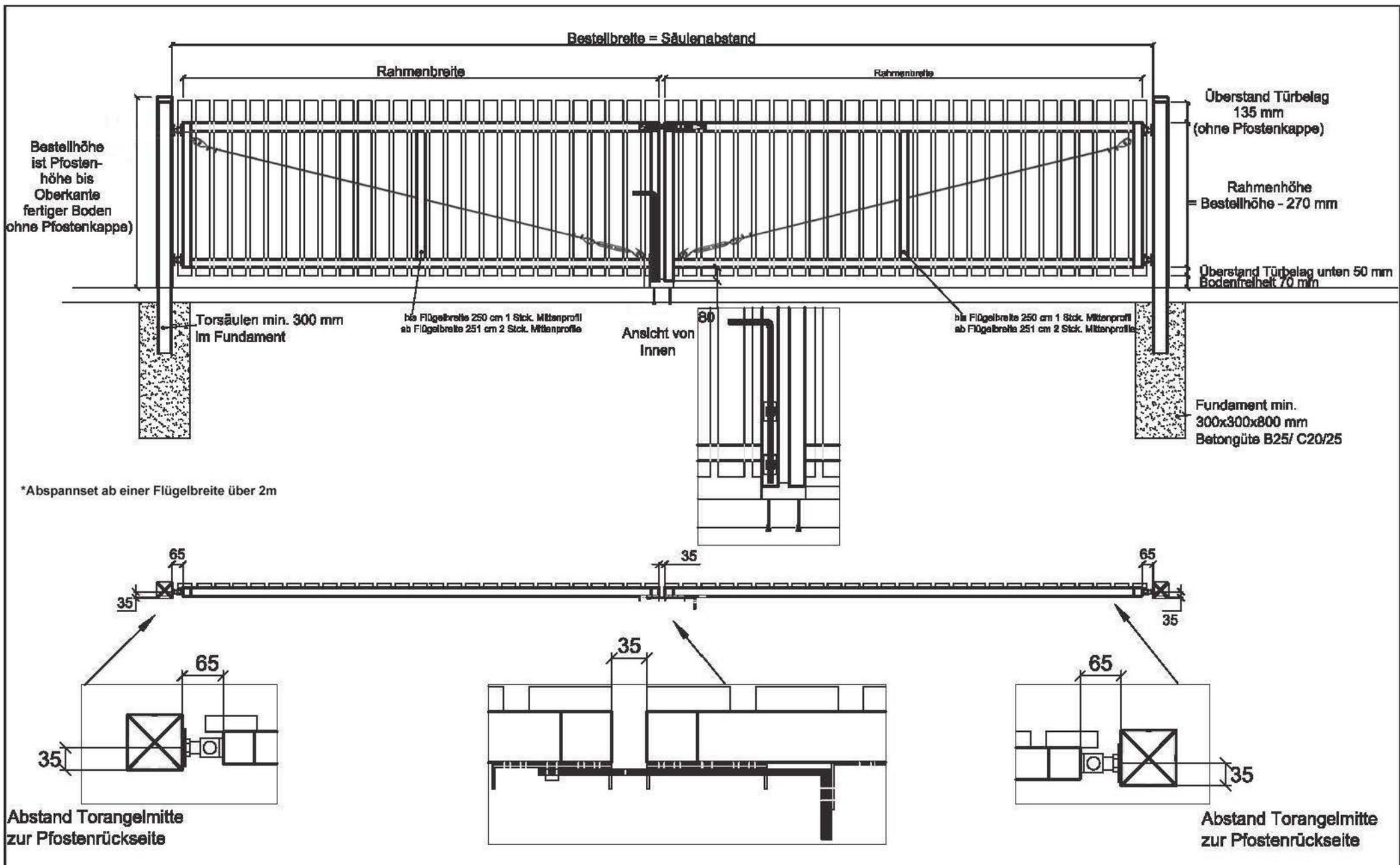
Bauteil: Drehtor 2-flügelig ohne Antrieb
