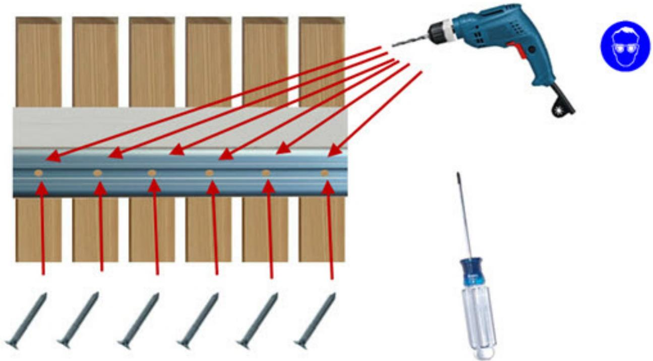
Falls Sie die Bausatzvariante ohne Belag bestellt haben können Sie auch einen eigenen Belag (zum Beispiel Holz- oder Alulatten) montieren.
