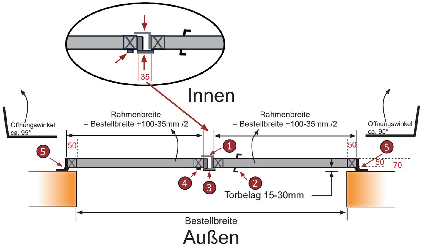
Montage DIN Links und DIN Rechts möglich
