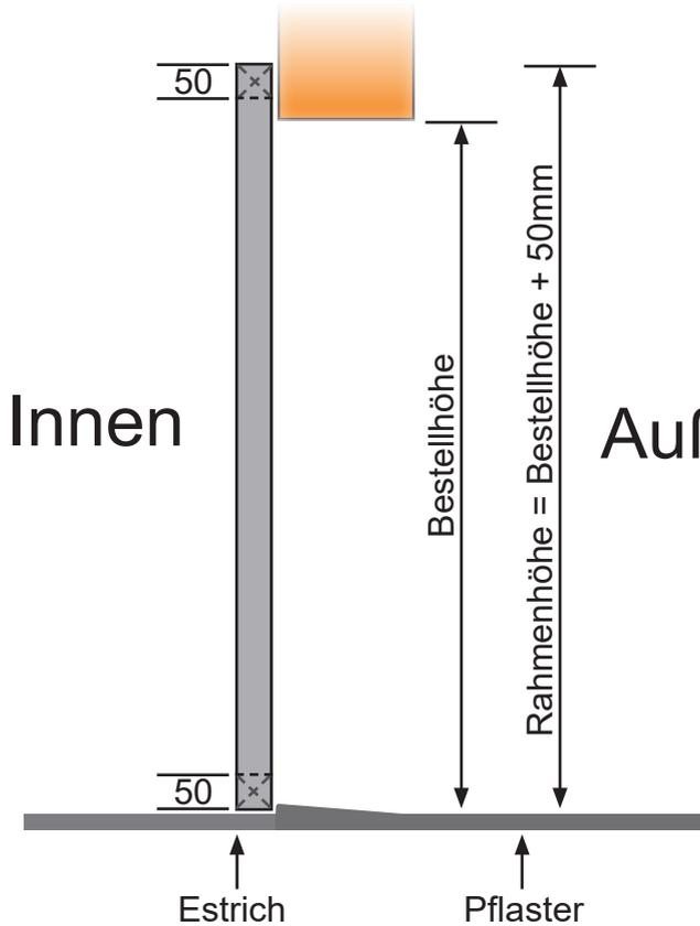
Bei Bedarf kann bauseits ein Estrich-Anschlagwinkel angebracht werden.
