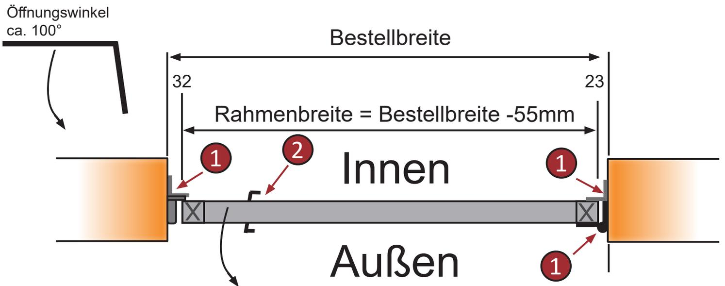
Montage DIN Links und DIN Rechts möglich
