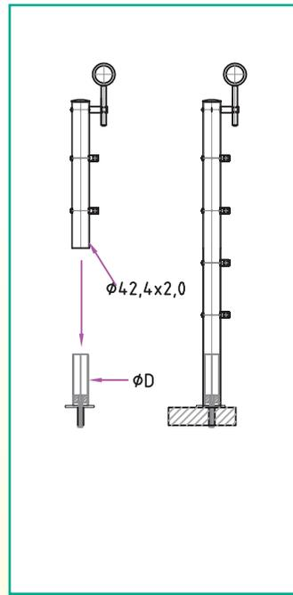
Pfostenbefestigung für freitragende Treppenstufen
