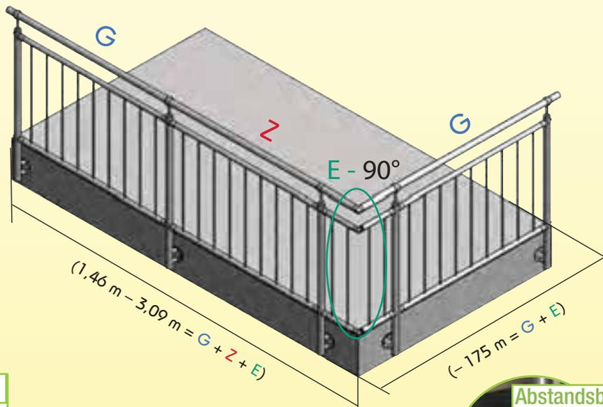
**Diese beiden Eckmodule sind auch bei aufgesetzter Montage zu verwenden!**
