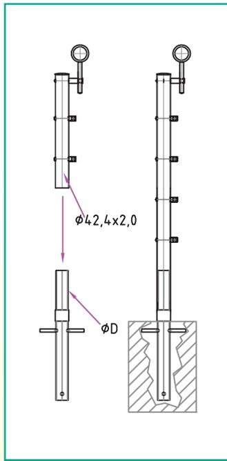
Pfostenbefestigung zum Einbetonieren
