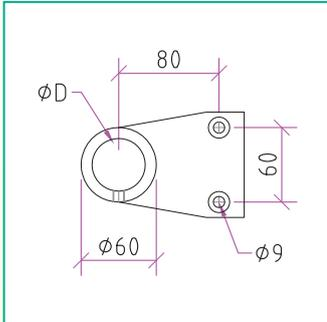
**Germany** Pfostenbefestigung für freitragende Treppenstufen
