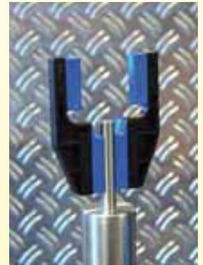
Montagevorrichtung ist fertig präpariert und wird durch Aufschieben mit dem Trägerpin verbunden
