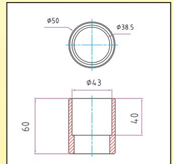
🇩🇪 Ausrichtungswerkzeug, Aluminium
