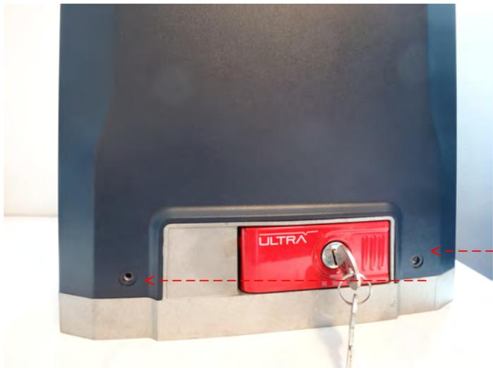
Beide Frontschrauben lösen
