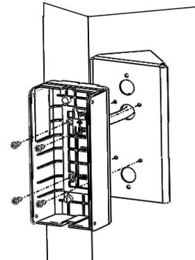
Montageschrauben für Sensor (im Lieferumfang des Sensors enthalten)
