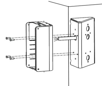
Montageschrauben für Sensor (im Lieferumfang des Sensors enthalten)
