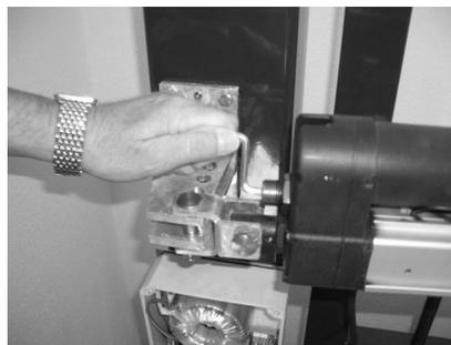
Mit dem beiliegendem Imbus-schlüssel mit einer rechts / abschrauben links Drehung (je nach Einbau-situation) den Druck, die Spannung vom Tor nehmen.
