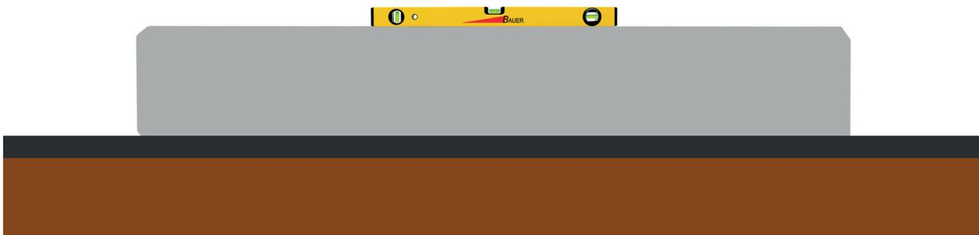
Nutzen Sie bei Bedarf unsere Höhenausgleichs-Antirutschmatten um das Fundament auf Beton oder Asphalt im Wasser auszurichten (Be Komplettstranken im Lieferumfang).
