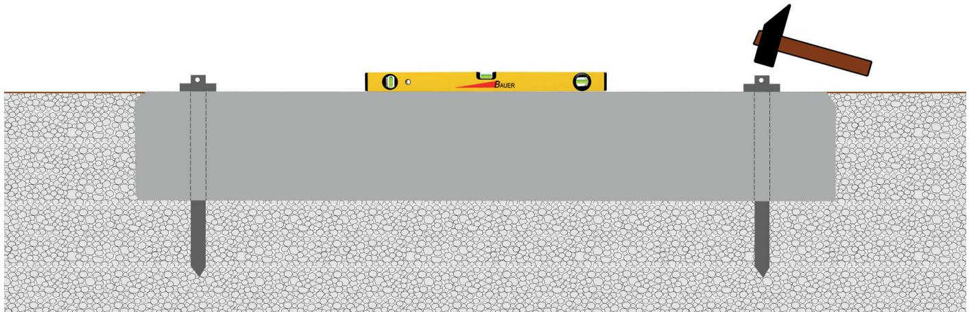
Nachdem das Fundament mit der vorinstallierten Schranke ordnungsgemäß gesetzt wurde, kann der Anbau des Schrankenbaums laut beiliegender **Hersteller-Montageanleitung** erfolgen.
