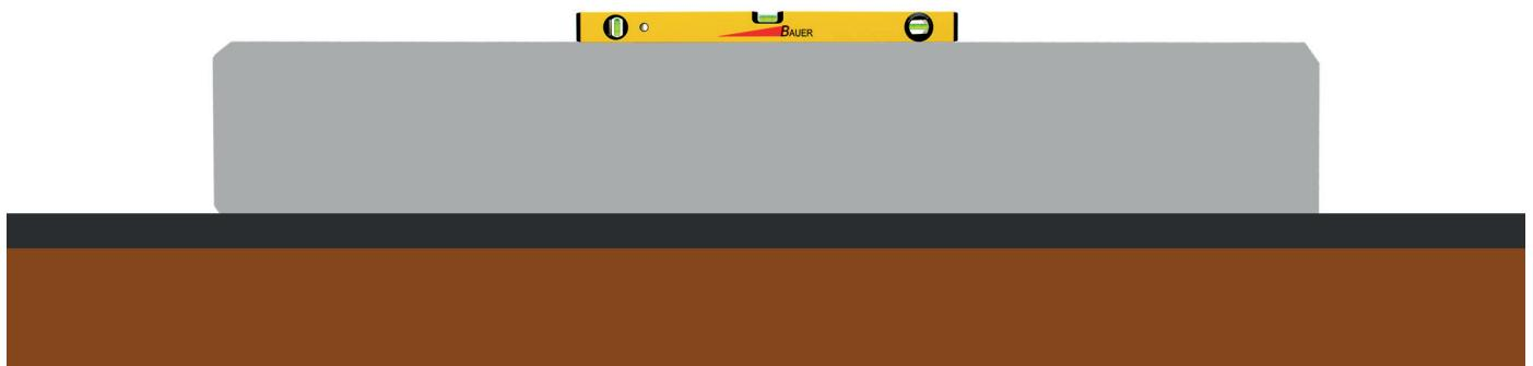
Nutzen Sie bei Bedarf unsere Höhenausgleichs-Antirutschmatten um das Fundament auf Beton oder Asphalt im Wasser auszurichten (Be Komplettschränken im Lieferumfang).
