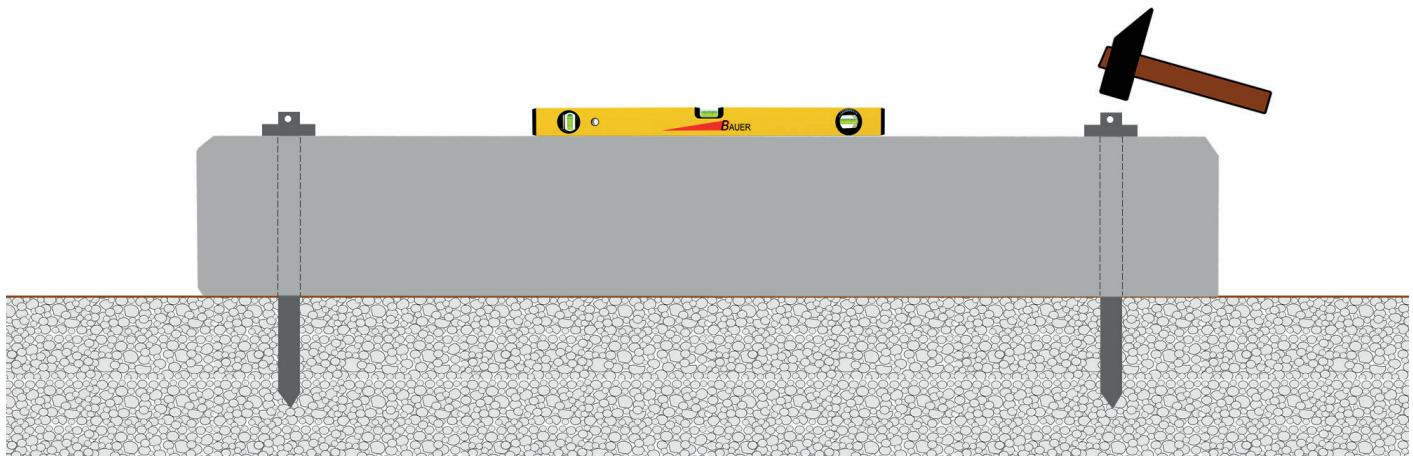
Fundament ebenerdig in Kies / Mutterboden / Schottergrund
