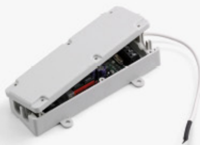
MX00 AU 01H 0W 00 Unité de contrôle 1 moteur avec récepteur intégré (230Vac) Kontrollinheit 1 Motor mit integriertem Empfänger (230Vac)
