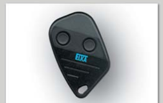
SKJ-Funk MINI ohne Codierschalter, Code ler- nen nur in Verbindung mit SK- SKX- oder SKI-Handsender, gute Reichweite, 2-Kanal, der ideale Zweithandsender fürs Schlüsselbund, 434MHz
