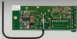
Steckplatz für optionalen ELKA-Funkempfänger, 434MHz, für 1- bis 3-Kanal-Handsender
